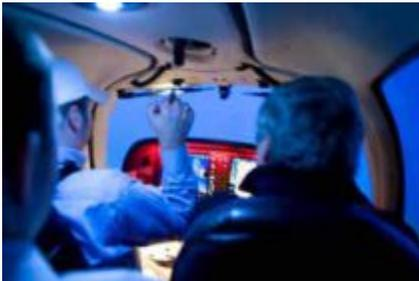
**Ativação do CAPS** - Para ativar o sistema do CAPS, o piloto (ou passageiro) remove a capa da alavanca do CAPS e puxa a mesma, localizada no teto da aeronave, entre o piloto e o co-piloto. A alavanca deve ser puxada em um movimento constante, com ambas as mãos. É necessária uma força de cerca de 45 libras (20kgs), e duas polegadas de deslocamento da alavanca, para que o sistema seja acionado.
