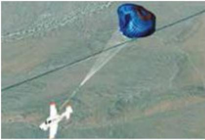
**Abertura do paraquedas** - No início da sequência de acionamento, o anel de slider fica localizado no topo das linhas, próximo ao paraquedas. Conforme as cargas aerodinâmicas do preenchimento do velame aumentam, o slider se move para a parte de baixo das linhas, permitindo uma abertura completa do paraquedas. Durante este processo, a aeronave irá passar de uma atitude de nariz alto para uma atitude picada, até que os line cutters estendam totalmente o tirante traseiro.
