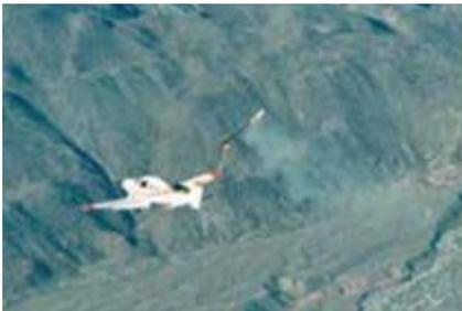
**Extração do foguete e do paraquedas** - Quando a alavanca é puxada, o cabo faz com que o foguete dispare e remova a capa do compartimento do paraquedas, localizado atrás do bagageiro. O foguete extrai a bolsa contendo o paraquedas dobrado de dentro da aeronave. Esta bolsa protege o paraquedas até que esteja distante da aeronave e garante que o mesmo se abrirá da maneira correta.
